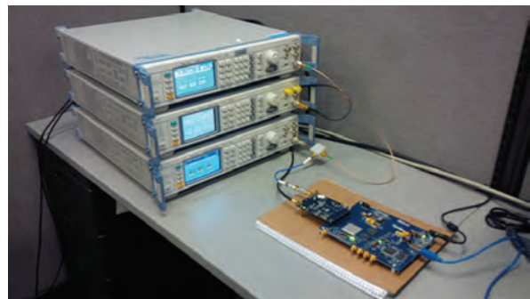
Рис. 13. Внешний вид тестового оборудования и демонстрационной платы, с помощью которой осуществляется тестирование AD6676
